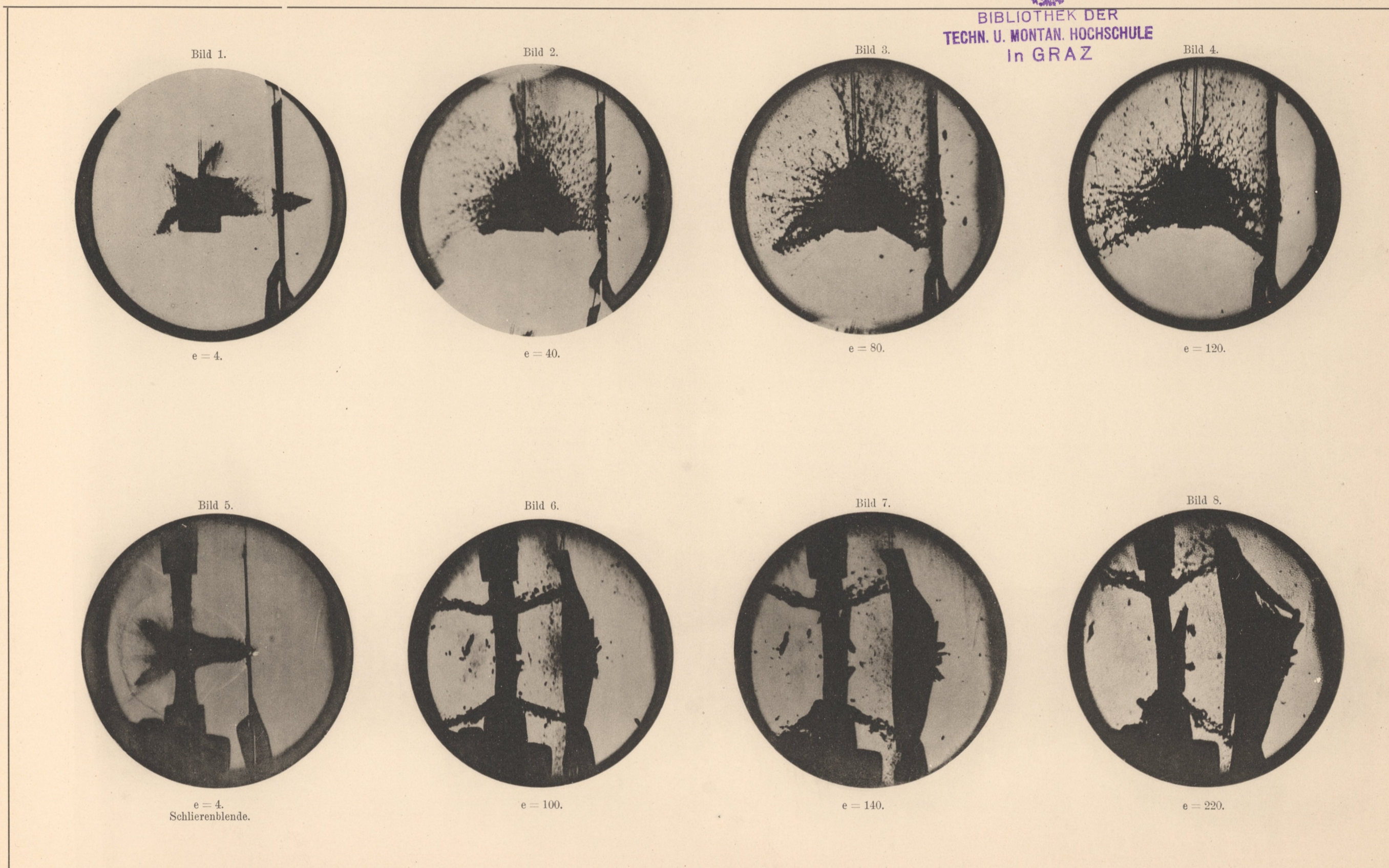
e = Geschossweg vom Beginn des Austrittes des Geschosses aus dem Mark bis zur Aufnahme in cm. 0,37 der natürlichen Grösse.
