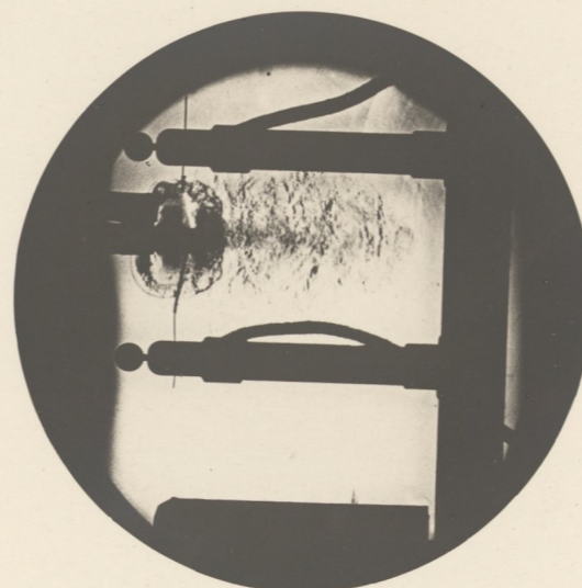
Geschoss hat den Lauf soeben verlassen.
