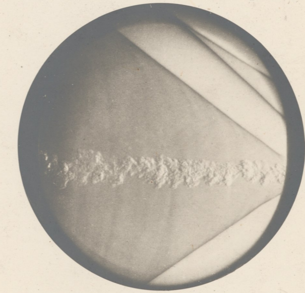
Schusskanal und Kopfwelle eines Geschosses 88.
