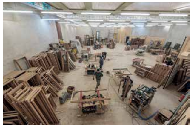
Abb.20: Blick in die Feldwerkstätte der Fenstertischler während der Restaurierung der rund 720 bauzeitlichen Fenster des Österreichischen Parlamentsgebäudes in Wien.
