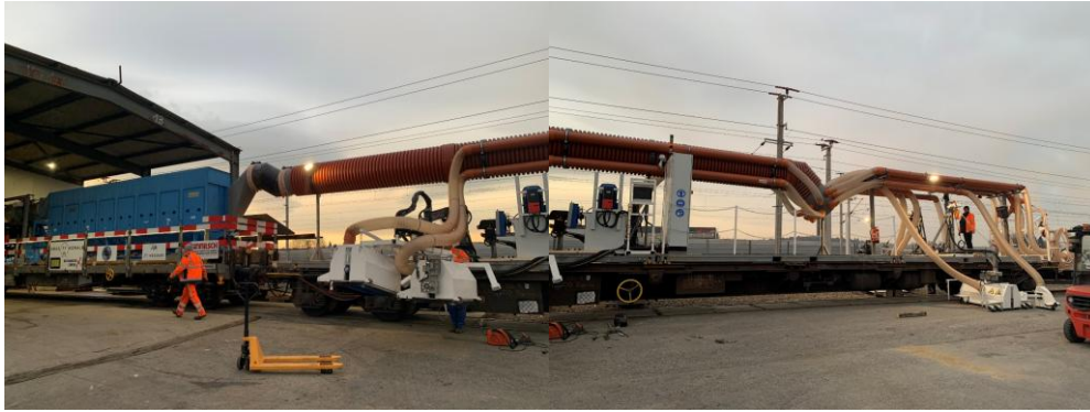
Abbildung 2 Reinigungszug für Tunneltrockenreinigung
