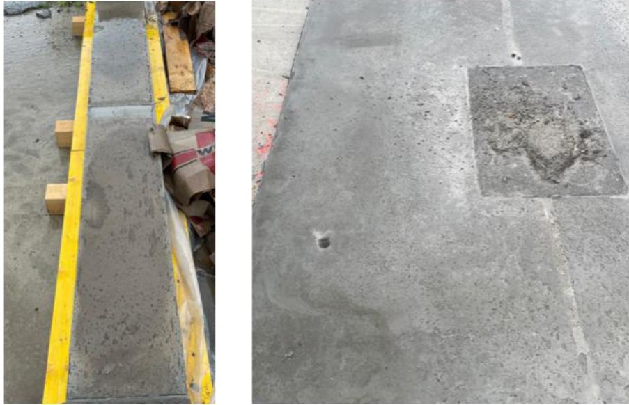
Abbildung 9 Positive Prüfergebnisse im modifizierten L-Box Versuch (links) und im Vergleich dazu das Ergebnis am Probefeld
