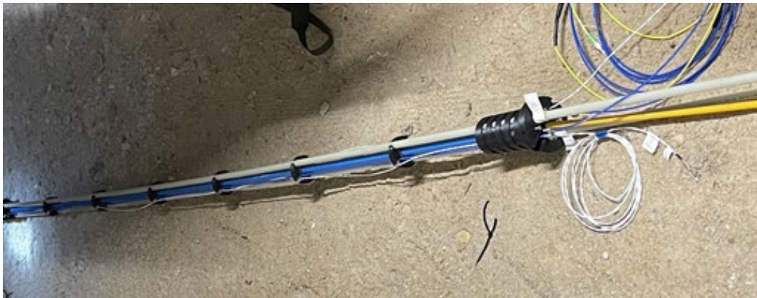
Abb. 2: Flexibles magnetostriktives Extensometer mit zwei Dehnungsfasern und Verfüllschlauch.
