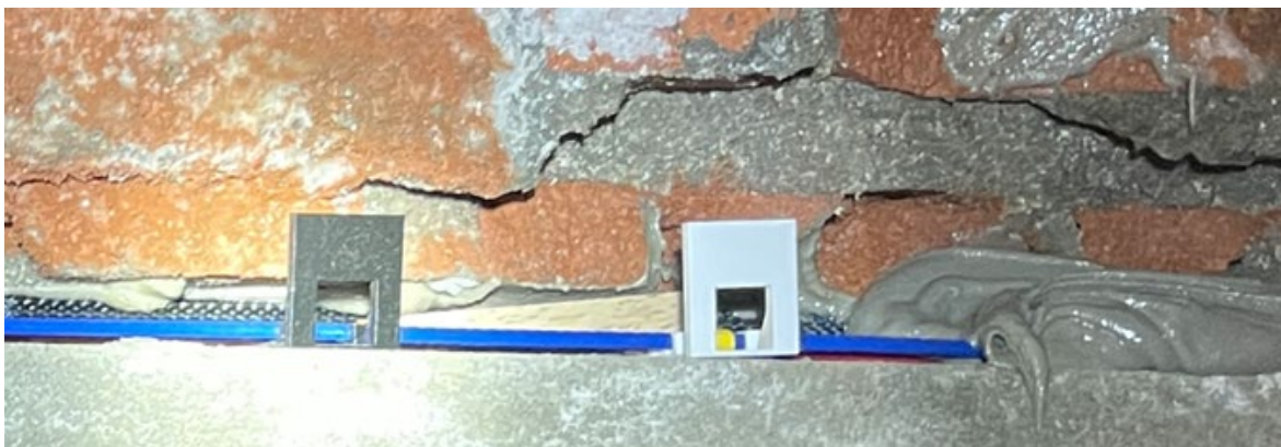
Abb.7: Messhorizont mit Abstandshalter, Faserkabel und Verbundwerkstoff.
