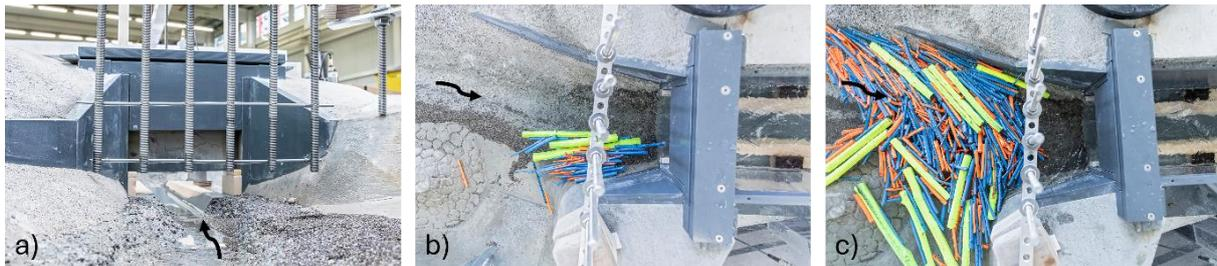
Abbildung 3: optimierter schwebender Schwemmholzrechen vor der Drossel (mit überhöht eingebauten Rechenstäben) a) in der Frontalansicht, b) nach Schwemmholzzugabe bei  $6 \text{ m}^3/\text{s}$  und c) nach Schwemmholzzugabe bei  $7.2 \text{ m}^3/\text{s}$
