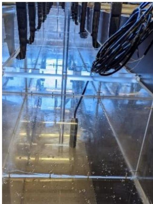
Abbildung 2: Installiertes Messpaar mit Standrohr und Drucksensor
