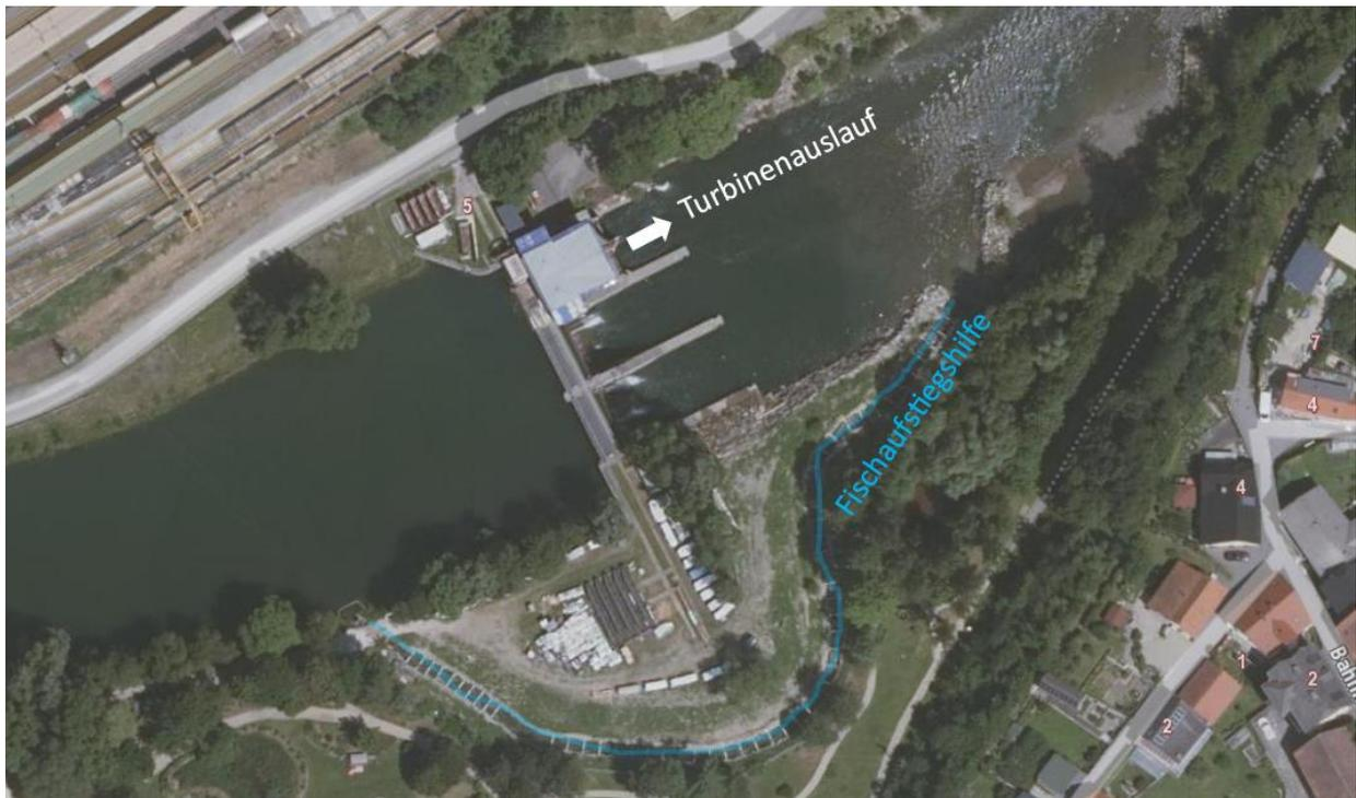
Abbildung 1: Übersicht der Wehranlage mit Turbinenauslauf und Fischaufstiegshilfe
