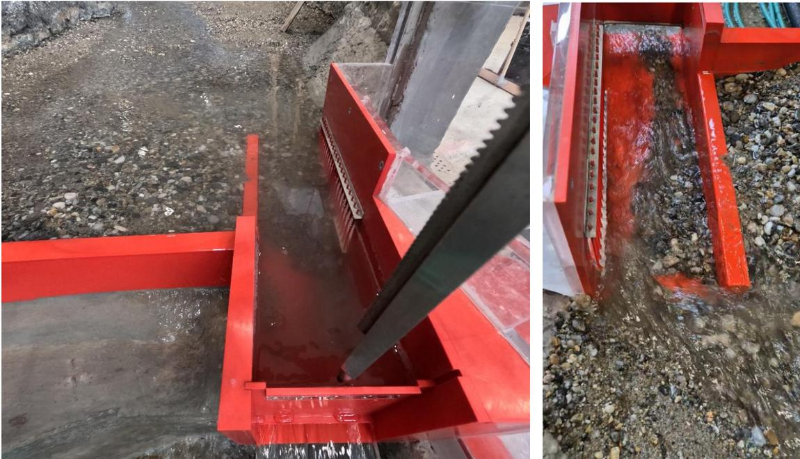
Abbildung 7: Spülung der Spülgasse im Modell bei einem Zufluss von 2 m<sup>3</sup>/s, links: vor der Spülung, rechts: während der Spülung
