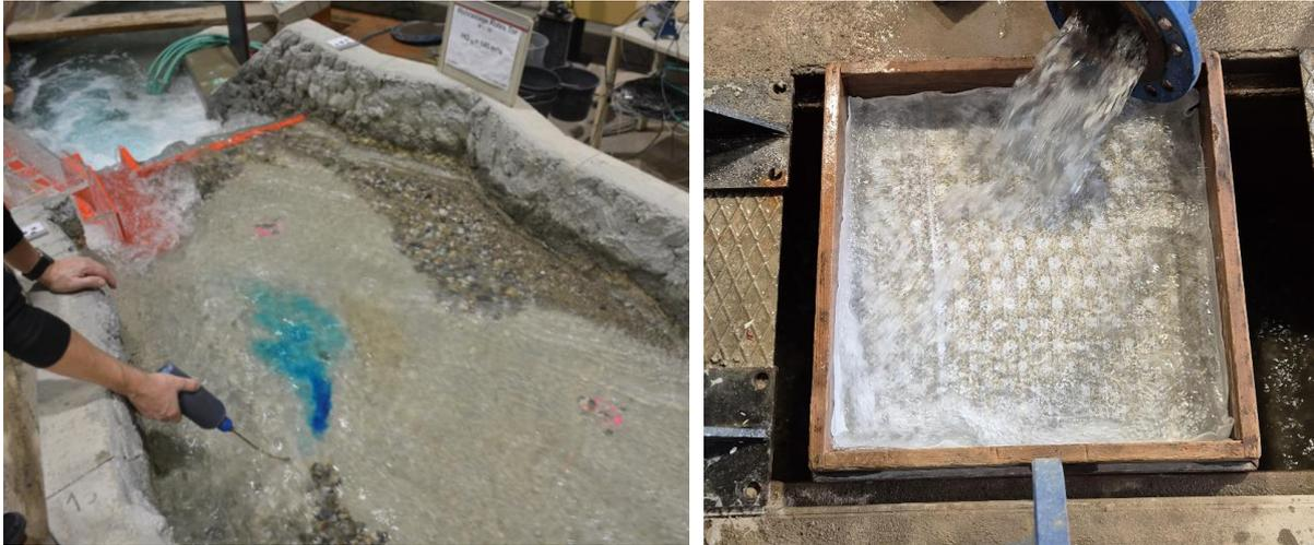
Abbildung 4: Links: hydraulisch Situation bei HQ10 mit befestigter Sohle; Rechts: Auffangvorrichtung für Feinsedimente
