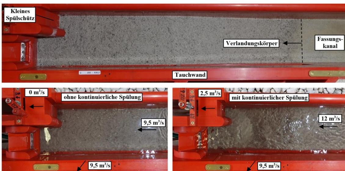
Abbildung 6: Ausgangszustand der Verlandung im trockenen Modellzustand und die beiden Endzustände während der noch laufenden Versuche
