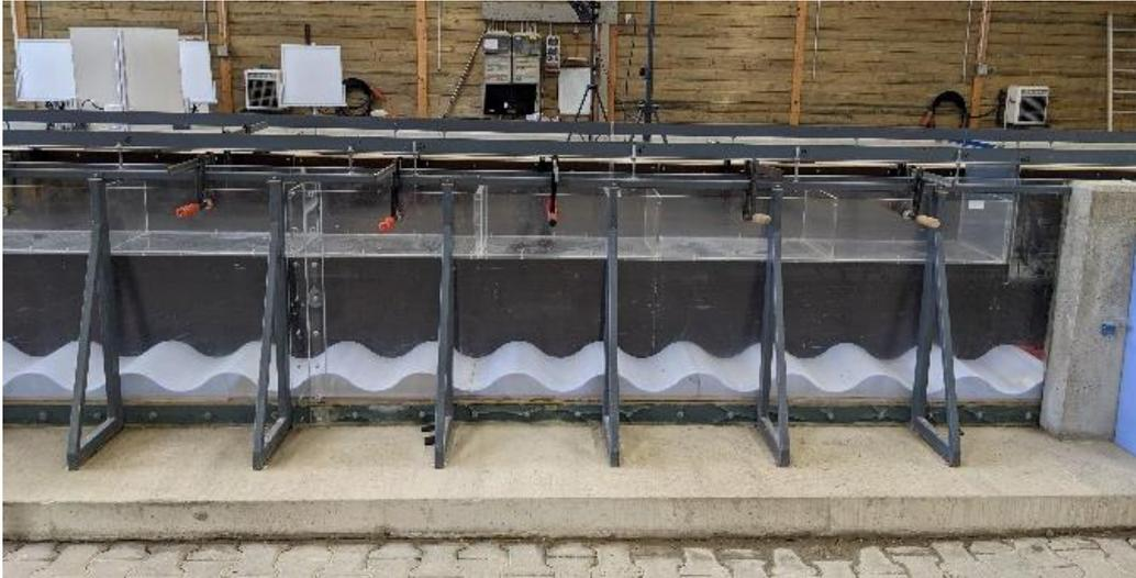
Abbildung 1: Seitenansicht des Versuchsaufbau mit Eisschicht und Dünensohle
