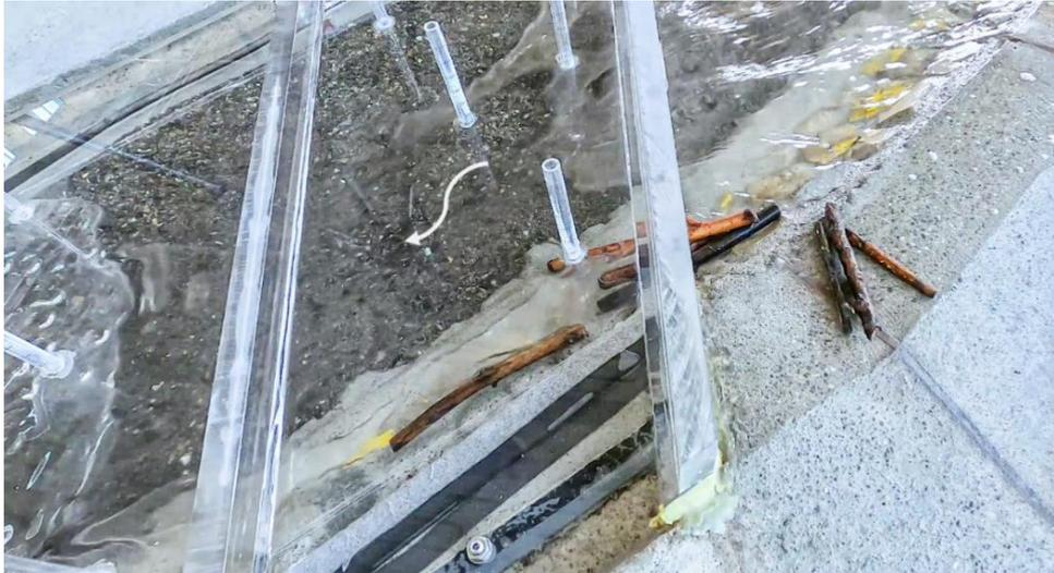
Abbildung 6: an der Druckbrücke verkeilte und über die Notentlastung entlastete Hölzer beim Ganglinienversuch HQ<sub>100</sub> mit Schwemmholzzugabe (SH3)
