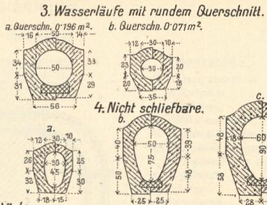
Kanalprofile aus Beton, die linke Hälfte für Romanzement- u. die rechte für Portlandzement-Beton.
