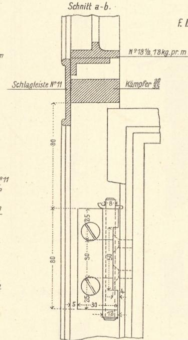
f. Detail eines Aufsatzbandes der unteren Flügel.
