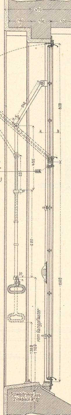
Öse zur Anbringung eines Vorhanges oder einer Strohmatten. (an jedem Fensterflügel 2 Stück)
