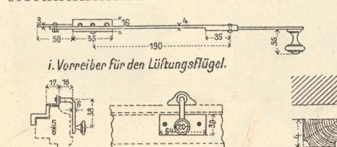
i. Vorreiber für den Lüftungsflügel.
