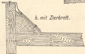
11. Sturmhaken für Unterdachkonstruktion bei Strangfalzziegeln.
