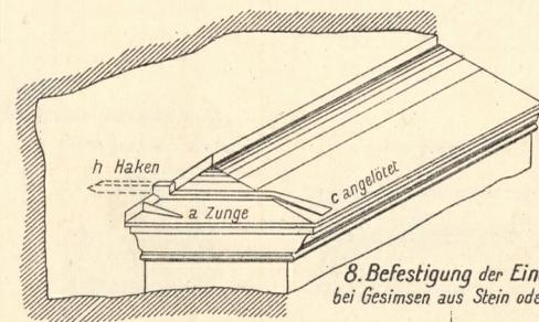
8. Befestigung der Eindeckung bei Gesimsen aus Stein oder Beton.
