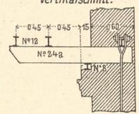
2f. Eisenkonstruktion für den Balkon.
