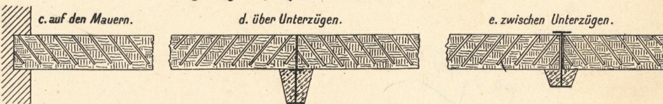
Kassettendecke aus Eisenbeton von Arch. v. Wielemans.
