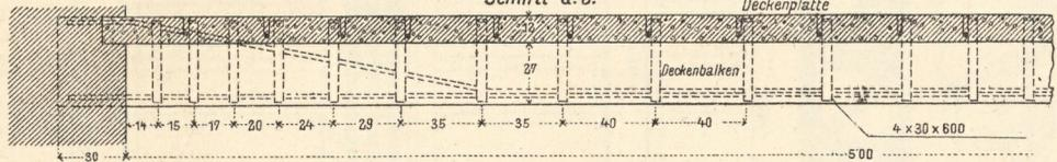
3. Voutendecke, System Koenen für Spannweiten bis zu 5m.
