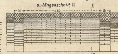
23. Tonnengewölbe mit Verstärkungsgurten.
