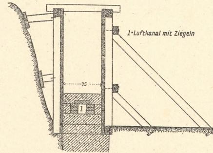
7. Betonierung von Rauch- und Ventilationsschloten.
