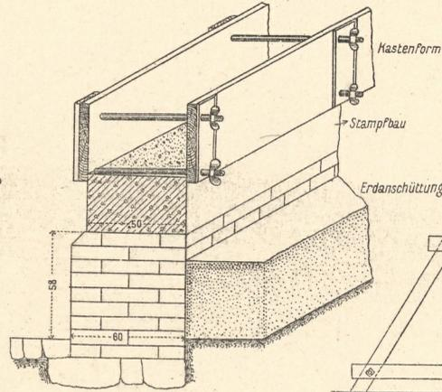
5. Betonmauerwerk mit Einschalung.
