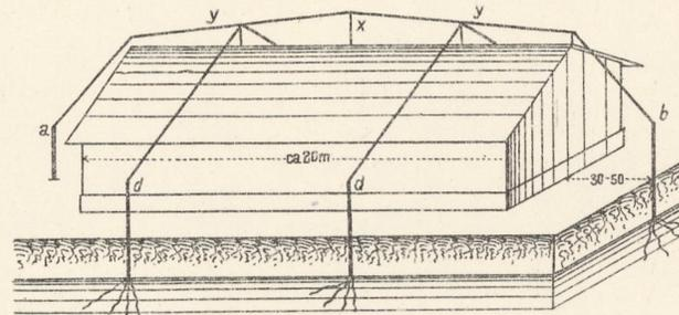
10. Befestigung des Drahtseiles an die Auffangstange.
