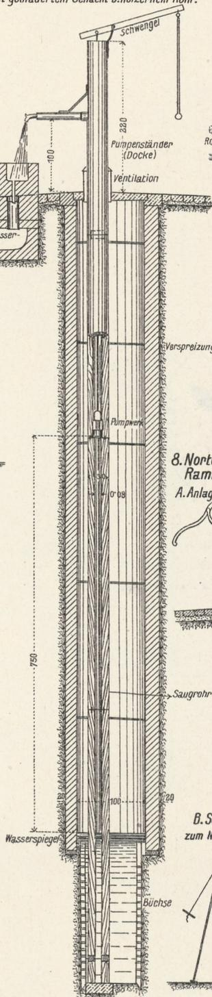
3. Brunnenanlage mit oben gemauertem u. unten gebohrtem Schacht mit eisernem Rohr und Radantrieb.
