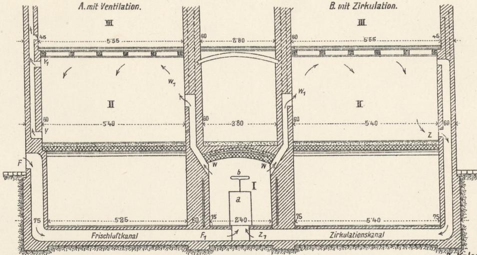
I Heizkammer mit a. Heizkörpern, b. Wasserbehälter, Z. Zirkulations-, F. Frischluftkanäle.
