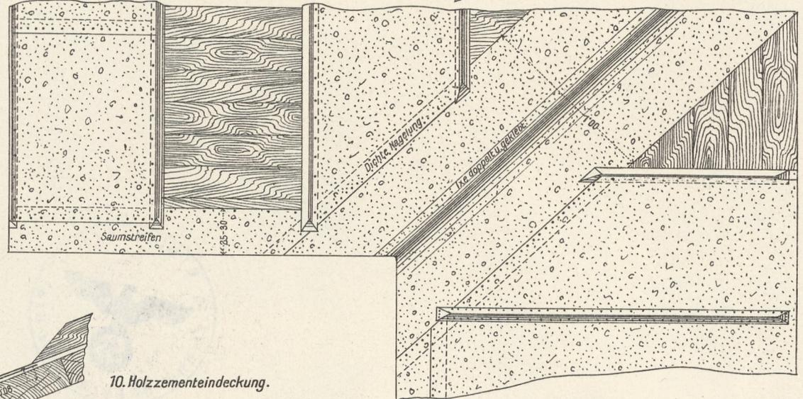
4. Querschnitt der Leistenüberdeckung.
