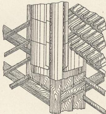
8. Eindeckung mit Hakenfalzplatten aus Portlandzement. Ganze Hakenfalzdachplatte.
