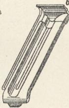
c. Querschnitt des Falzziegels.
