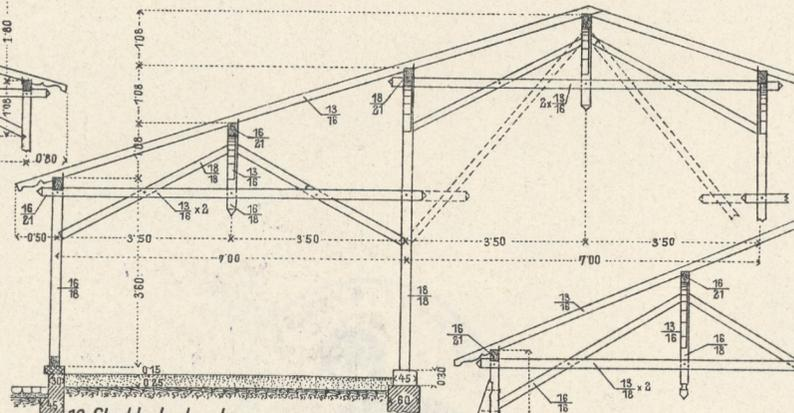
7. Dachreiter bei Riegelbauten mit 2 Mittelständern.
