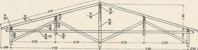
6. Satteldach bei Riegelbauten mit zwei Mittelständern.
