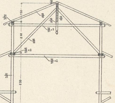
8. Holzzementdach für Riegelbauten.
