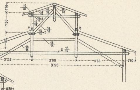
5. Satteldach bei Riegelbauten mit einem Mittelständern.
