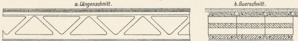
3. Eisenbetondecke mit Unterzügen und Füllungsträgern, Syst. Visintini.
