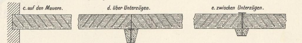
Kassettendecke aus Eisenbeton von Arch. v. Wilemans.
