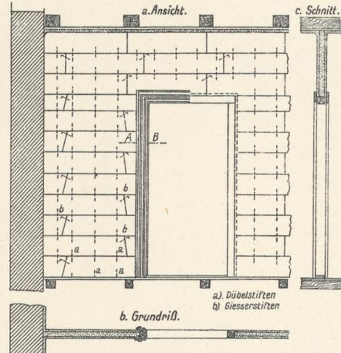
7. Gipsschlackenwände mit tragendem Eisendrahtgerippe.
