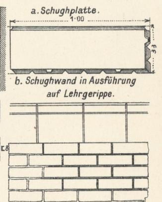
6. Korksteinverkleidungen zur Isolierung gegen Kälte oder Wärme.
