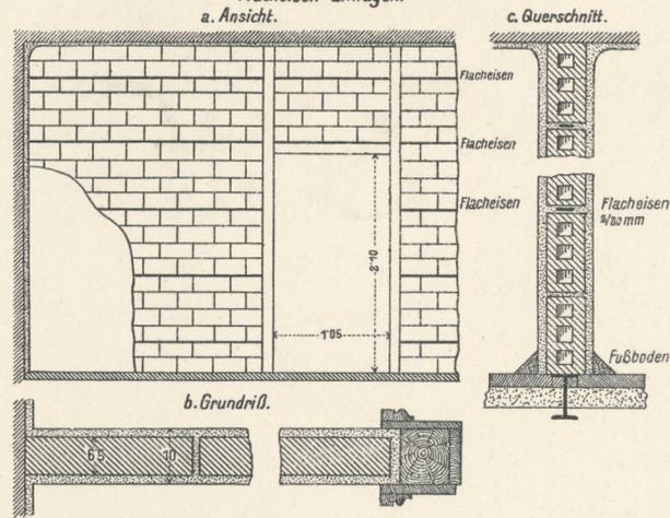
2. Wandkonstruktion, System Prüss mit Flacheisen-Einlage.
