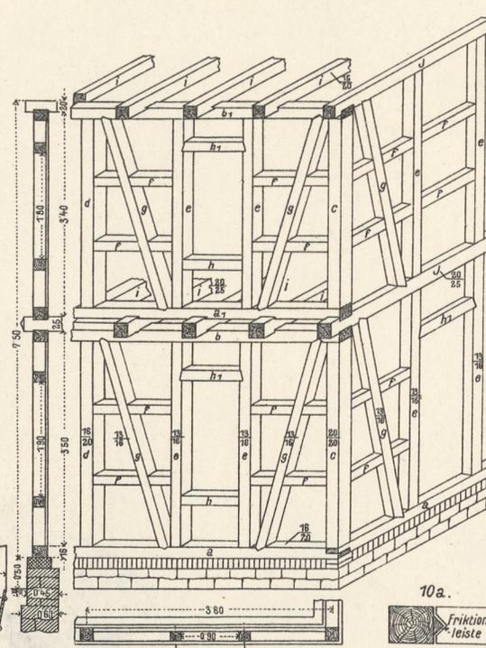
Detail-Konstruktionen zum Riegelbau.
