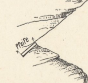
d. Winkung bei zu tiefem Bohrloch.
