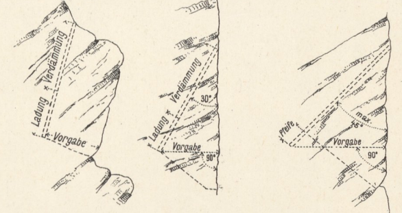
d. Winkung bei zu tiefem Bohrloch.
