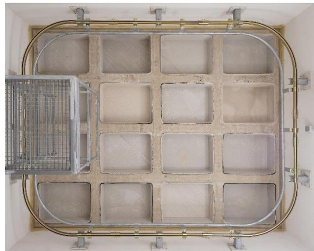
**Abbildung 10** Deckenprüfling eingebaut im Deckenprüfstand, Ansicht von unten
