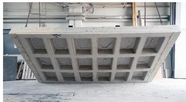
**Abbildung 12 Befeuerte Seite nach dem Brandversuch unter Last**
