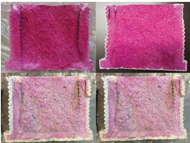
**Abbildung 9** Proben zur Ermittlung der Karbonatisierungstiefe nach 0, 7, 28, 38 Tagen
