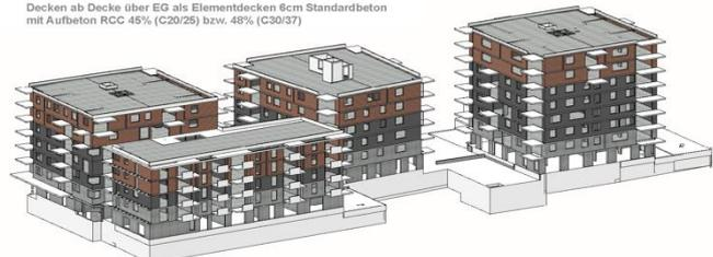
**Abbildung 8 Ausschreibungsbeilage zu Ausführungsvarianten für die Vorgabe eines GWP-Reduktionsziel für die Primärkonstruktion aus Beton mit Bezug auf den GWP-Katalog der öbv.**
