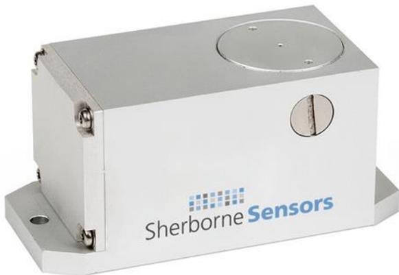
**Abbildung 7** Messaufnehmer aus dem Flugzeugbau (Airbus A-380) der Marke Sherborne (Ultra-low range accelerometer) mit einer G-Range von 0,1g und einer Auflösung von 0,0005%.)
