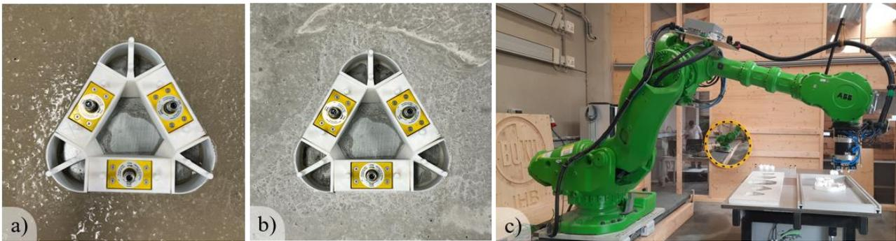
**Abbildung 7** Verwendung modularer Schalung für individuelle Öffnungen. a) 3D-Gedruckter Prototyp nach dem Einfüllen des Betons, b) 3D-Gedruckter Prototyp nach dem Aushärten des Betons, c) Anwendung und Verlegen der 3D-Gedruckter Prototypen mit 6-Achs-Industrieroboter
