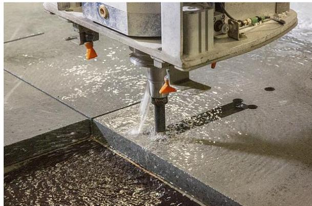
**Abbildung 2,** Ausfräsung in einer CPC Maßplatte Quelle Holcim (Deutschland) GmbH
