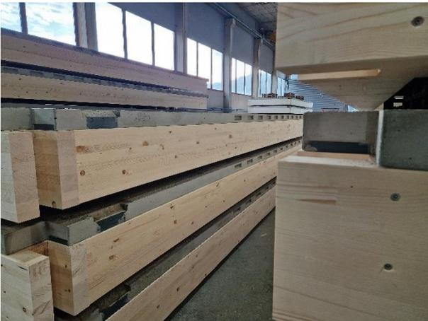
Abbildung 10 Hallenlagerung der HBV-Elemente
