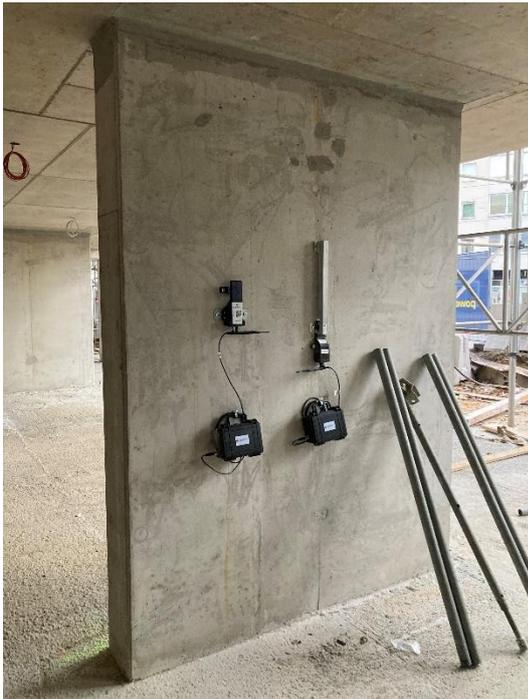
**Abbildung 2** Testphase eines links originalen 6D-Sensor und rechts des weiterentwickelten 6D-Sensor der Firma SuessCo Sensors GmbH
