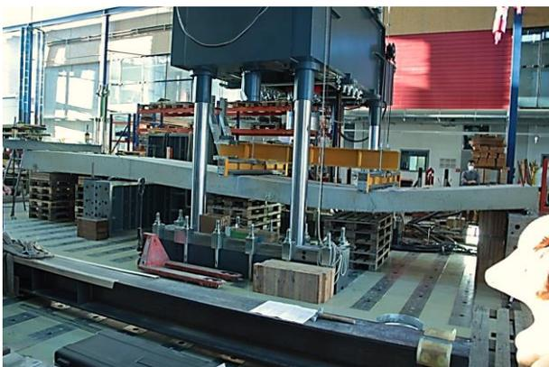
**Abbildung 7 Versagenszustand bei einem Maschinenweg von ca. 150 mm**
