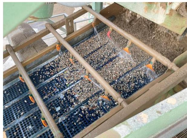
Abbildung 1 links: Kettenbagger mit Pulverisierer (Knabber) zur Vorzerkleinerung der Betonteile; rechts: Wasch- und Siebanlage zur Nassaufbereitung der gebrochenen RC-Gesteinskörnung
