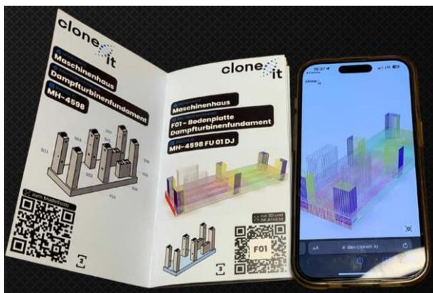
Abbildung 4 Modellhandbuch zur einfachen stets aktuellen Transmission der digitalen 3D BIM Modelle auf die Baustelle
