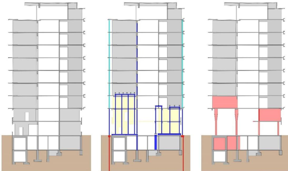
Abbildung 9 Umbaukonzept Eingangshalle: Bestand / Notsprößung und Abbruch / Neubau (© LM)
