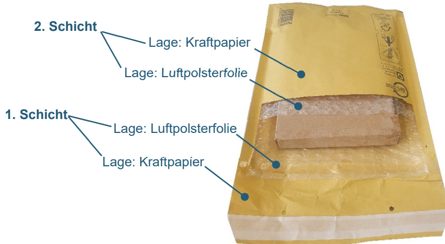
Abbildung 6: Aufbau einer Verpackung aus Kraftpapier und Luftpolsterfolie
