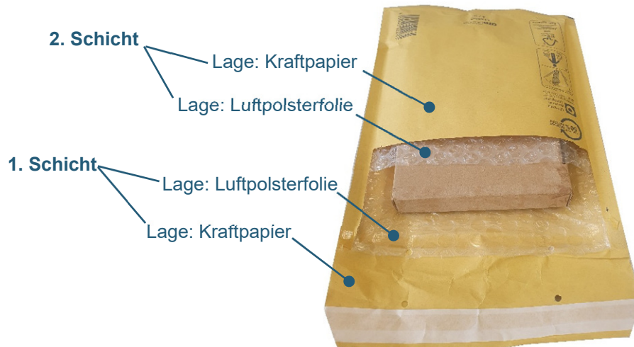
Abbildung 6: Aufbau einer Verpackung aus Kraftpapier und Luftpolsterfolie
