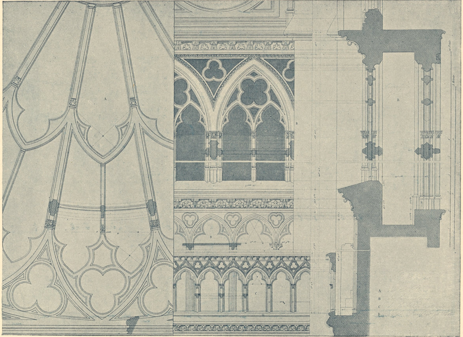
Fig. 258. Notre Dame zu Paris. Details des nördlichen Seitenportals. a) der Rosette, b) der Gallerie, c) der Balustrade, d) der Gallerie (Lassus und Violletle-Duc, Monogr. de N. D.).
