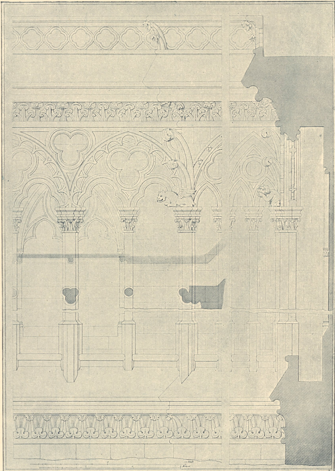
Fig. 261. Notre Dame zu Paris. Details der Säulengalerie (Lassus und Viollet-le-Duc, Monogr. de N. D.).
