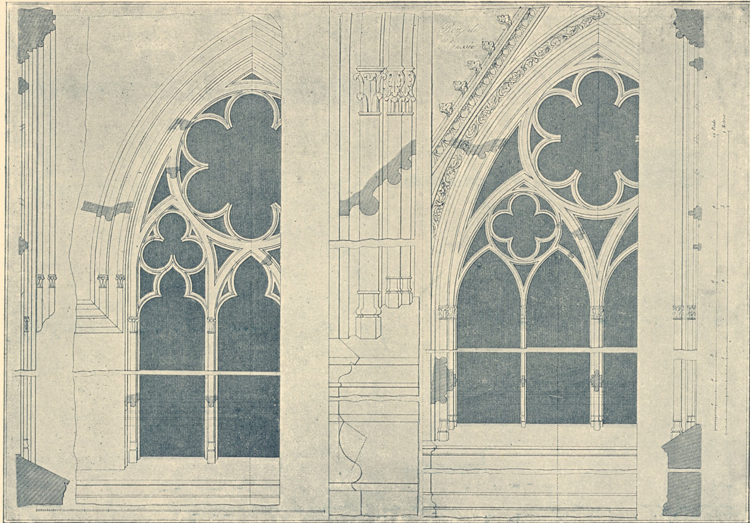
Fig. 257. Notre Dame Paris. Details des Masswerkes (Lassus und Viollet-le-Duc, Monogr. de N. D.).
