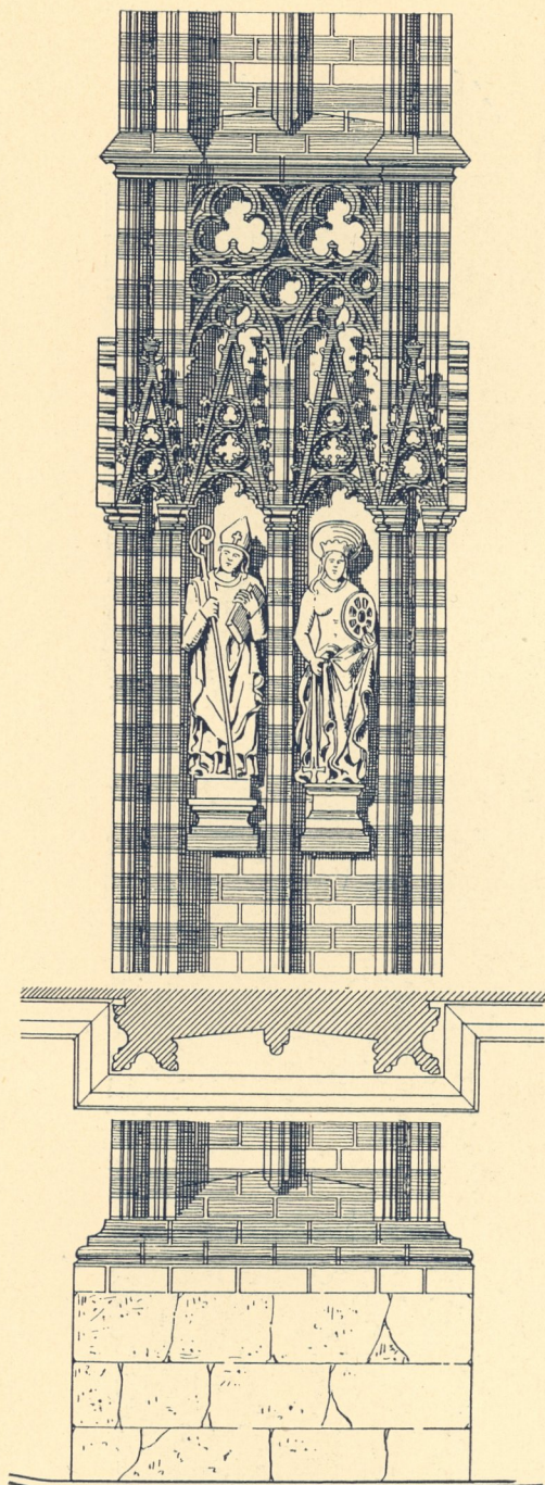
Fig. 87. Pfarrkirche St. Katherina in der Neustadt Brandenburg. Strebe Pfeiler. Nach Adler, Backsteinbauwerke.
