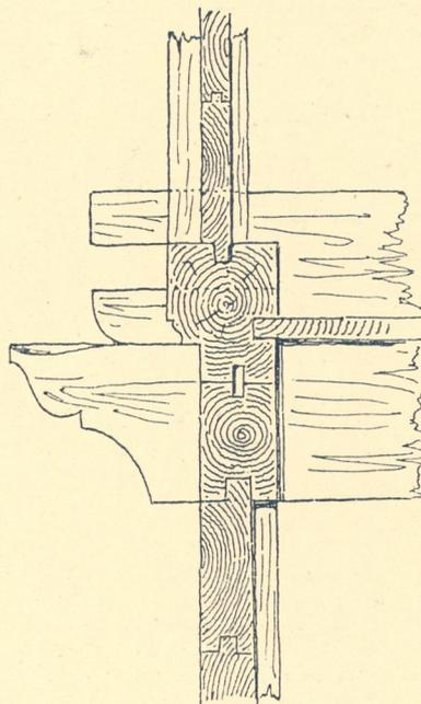
Holzverbindung der äusseren und inneren Wände der Schweizerhäuser.
