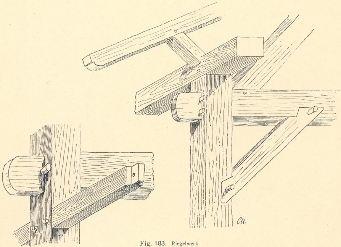
Fig. 183. Riegelwerk.
