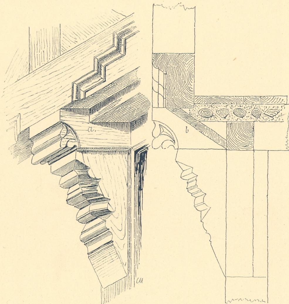
Fig. 182. Treppenfriesschwelle und Knagge, älteste Form. Braunschweig 1450–1490.
