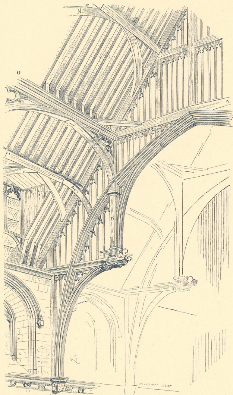
Fig. 438. Dachstuhl der Westminster-Halle in London. Nach Viollet-le-Duc.
