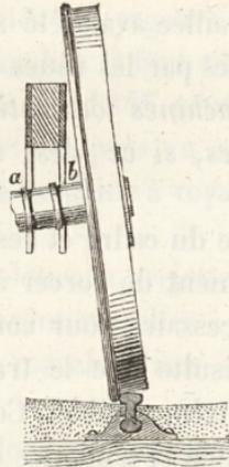
Fig. 461. — Rupture d'essieu avec châssis intérieur.
