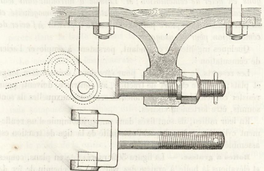
Fig. 367. — Support avec vis de rappel.
