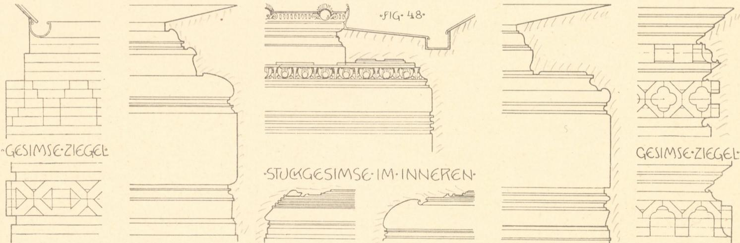
•FIG. 42•43• GESIMSE ZIEGEL • FIG. 44•45• FIG. 46 • HAUPTGES PUTZ • FIG. 47 • HAUPTGES PUTZ • FIG. 48 • HAUPTGESIMSE EISEN BETON • FIG. 49 • STUCKGESIMSE IM INNEREN • FIG. 50 • FIG. 44•45• GESIMSE ZIEGEL •
