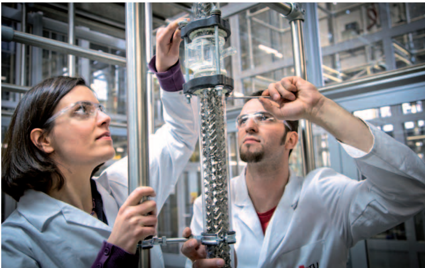
Montage einer Extraktionskolonne für Stofftransportuntersuchungen in der neuen Verfahrenstechnikhalle der TU Graz (E. Cvetkovic, P. Scherübel) Mounting of an extraction column for mass-transfer investigations in the new process-engineering hall of TU Graz (E. Cvetkovic, P. Scherübel)
