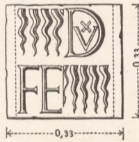
Nr. 94. Platten zwischen d. Sparrenköpfen des Dachvorsprungs.
