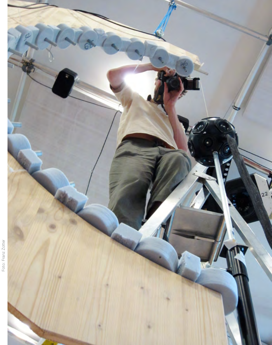
Akustische Messung der Abstrahlcharakteristik eines Kugellautsprechers im IEM-CUBE mit Prof. Balázs Bank aus Budapest, 2011.
