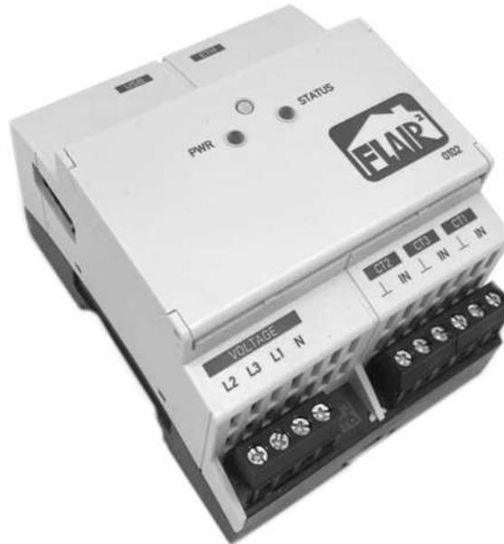
Abbildung 1 Prototyp des Steuer-Moduls mit integrierter Spannungs- und Strommessung zum Einbau im Reallabor.
