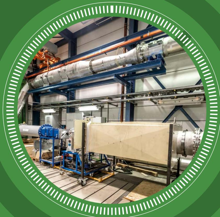
Im Turbomaschinenlabor am Institut für Thermische Turbomaschinen und Maschinendynamik der TU Graz untersucht Leiter Emil Göttlich mit seinem Forschungsteam die Aerodynamik von Flugzeugtriebwerken. Im Fokus steht das Turbine Center Frame – eine zentrale Komponente. Ziel sind aerodynamische und effiziente Flugzeugantriebe.
