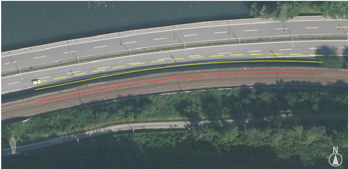
Abbildung 3-10: neuralgische Stelle der Nordausfahrt Graz; Gleisachse in rot, Achsabstand und Begrenzungslinie des Querschnittes in gelb
