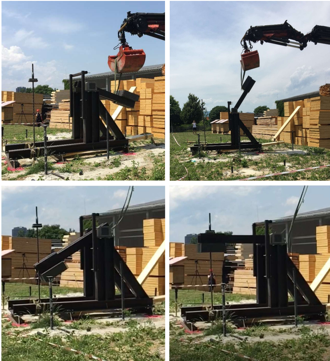
Abb. 36: Aufziehen des Pendels (oben links); Pendel auf Ausgangsniveau (oben rechts); Schwingvorgang des Pendels (unten links); Auftreffen des Pendels auf den Mikropfahl (unten rechts)
