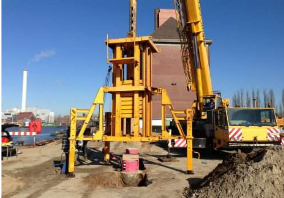
Abb. 12: Beispiel eines Versuchsaufbaues für DLT mit einem Fallgewicht (Allnamics, 2021)
