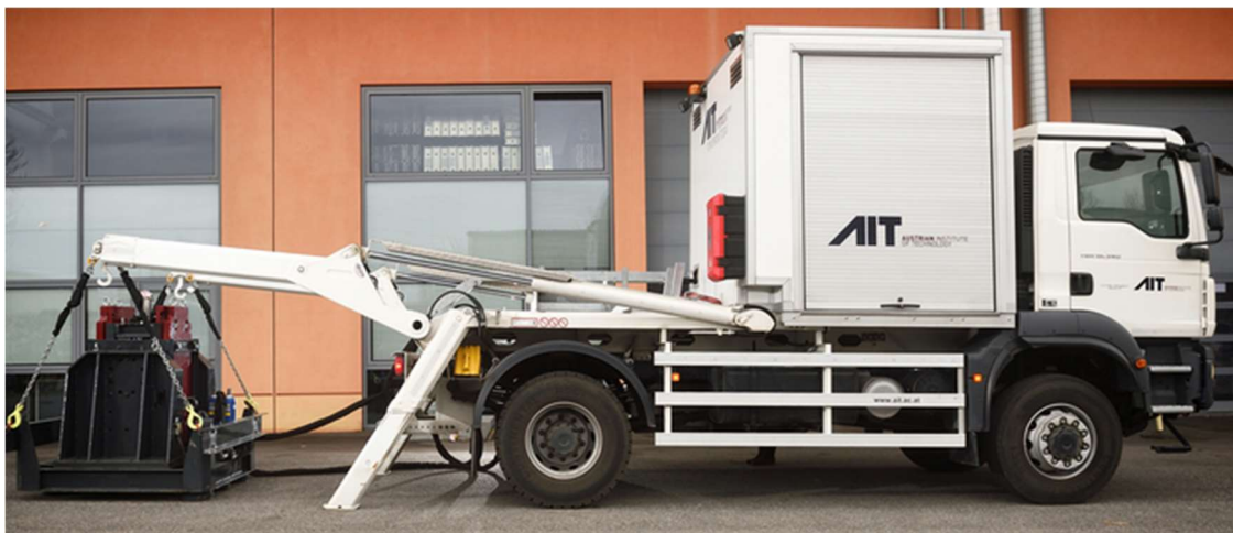
Abb. 11: Gesamtaufbau des Mobile Seismic Simulator (Austrian Institute of Technologie, 2021)
