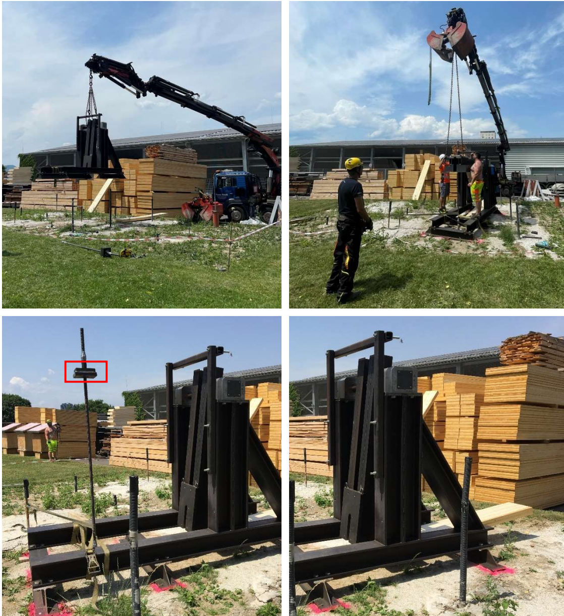
Abb. 35: Aufstellen des Prüfaufbaues (oben links); Einrichten des „Anschlages“ (oben rechts); Fixieren des Verlängerungsstabes (unten links); Versuchsaufbau inkl. der eingebauten „Bremse“ (unten rechts)
