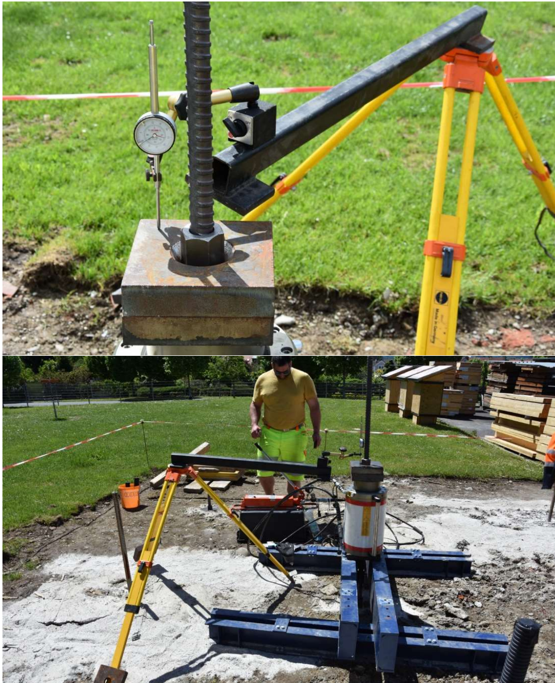
Abb. 31: Statische Zugversuche, (DAT, 2021); Aufbau Messuhr (oben); Prüfaufbau (unten)
