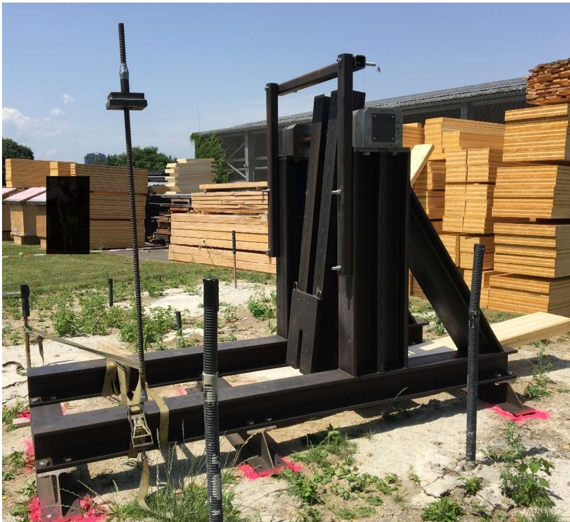
Abb. 32: Justierung für dynamischen Zugvorversuch an „C_GEWI_03“, (DAT, 2021)
