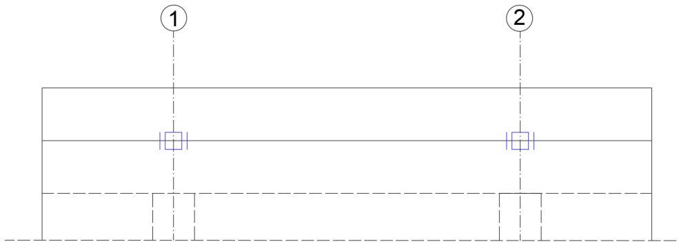
Abbildung 4.27: Lagerung unter dem Endquerträger
