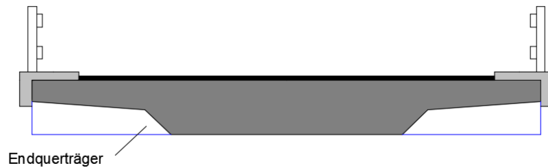
Abbildung 3.2: Vollplattenquerschnitt mit Endquerträger
