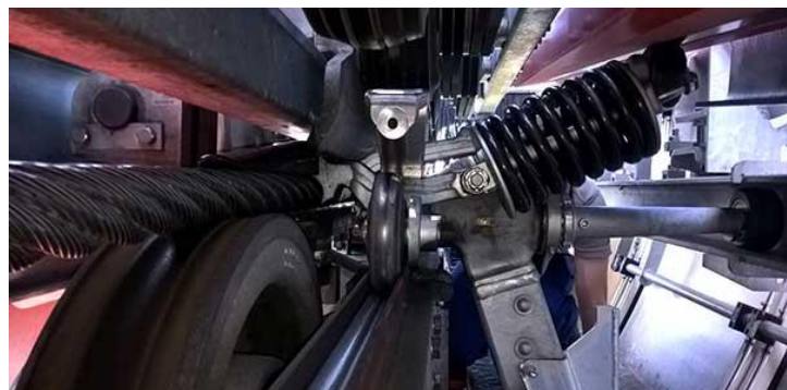
Abbildung 12: Kupplungseinrichtung (rechts oben)
