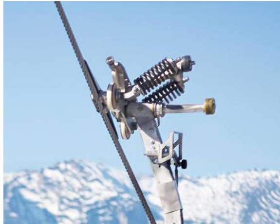
Abbildung 10: Klemme einer kuppelbaren Seilbahn
