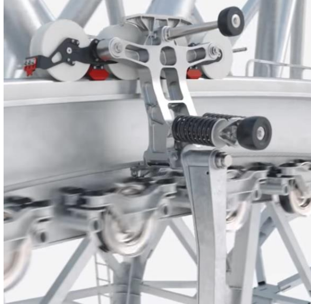
Abbildung 55: Hochgezogenes Tragseil in einem Zweiseilumlaufbahn
