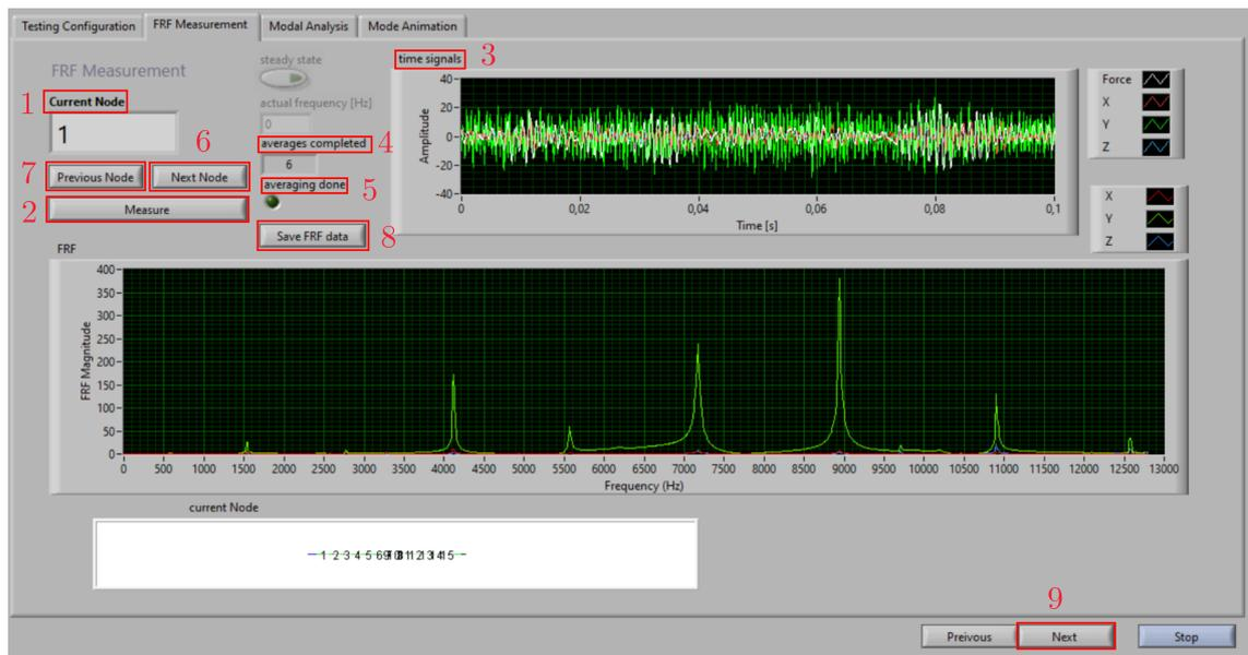
Abbildung B.13: White Noise: FRF Measurement
